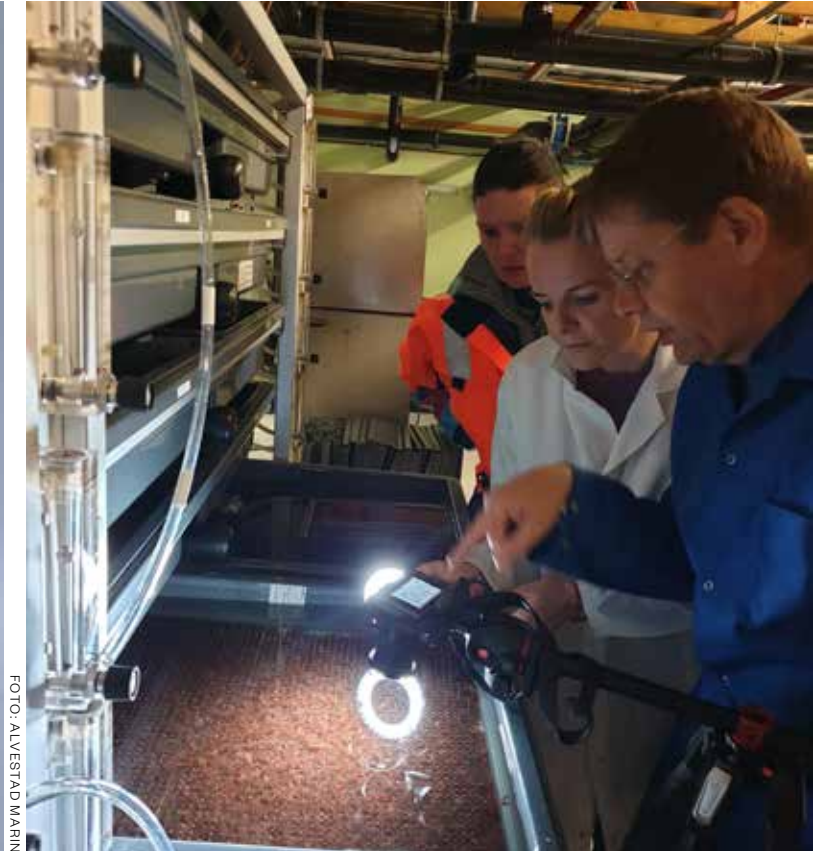
Studie av spektralanalyse med spesielle kamera og belysning på egg og yngel i samarbeid med SINTEF og AquaGen Kyrksæterøra.
