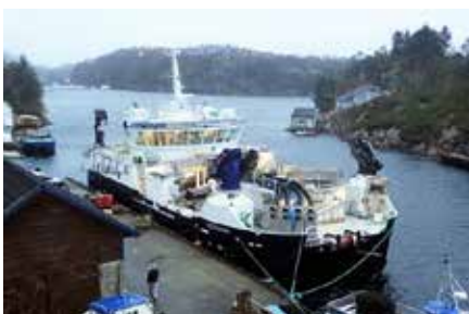
«Notmann» Akvakultur arbeidsbåt ombygget for avlusning med hydrolicer
