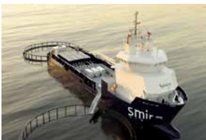
«Hydro Patriot» Ombygging av multifunksjons supplybåt til fremtidsrettet avlusningsfartøy innenfor havbruk.
